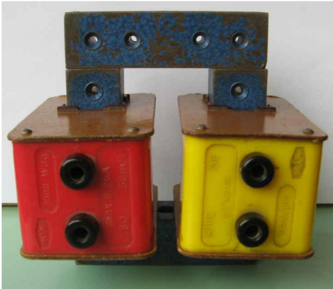
Il trasformatore elettrico. Applicazione tecnica del fenomeno di induzione elettromagnetica.
