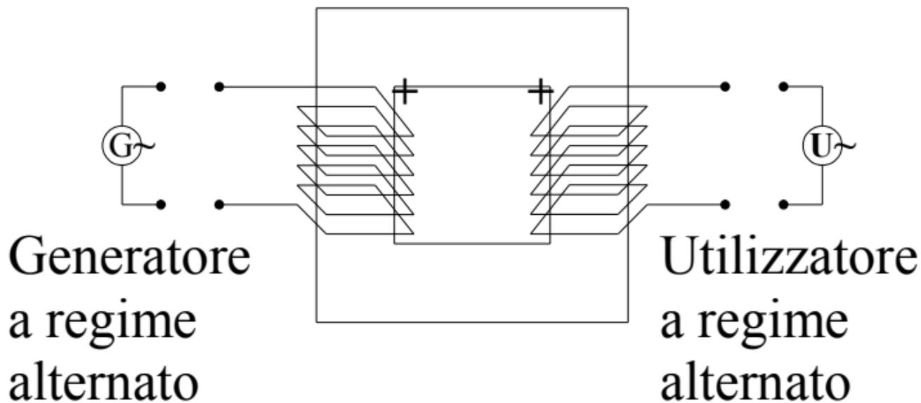
Ricerca. Struttura del trasformatore.
