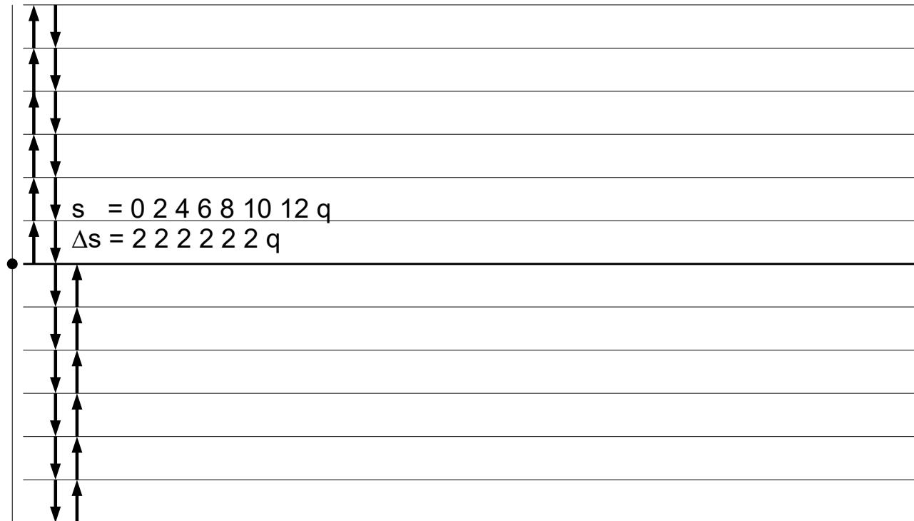
Moto rettilineo alternato uniforme, trasportato lateralmente con moto uniforme.
