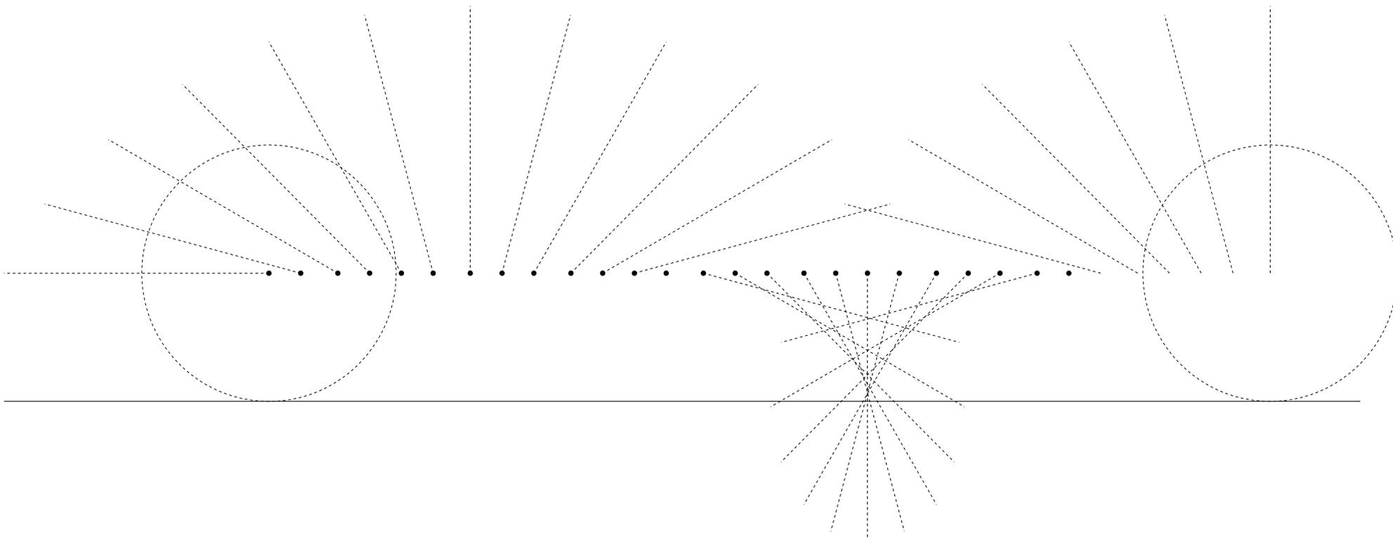
Tracciare la cicloide, a segmenti. 3 cicloidi: 1: Raggio lungo = estremo dei raggi del disegno; 2: cicloide-cicloide, R= raggio cerchio rotolante; 3: Raggio corto = 1,6 cm.
