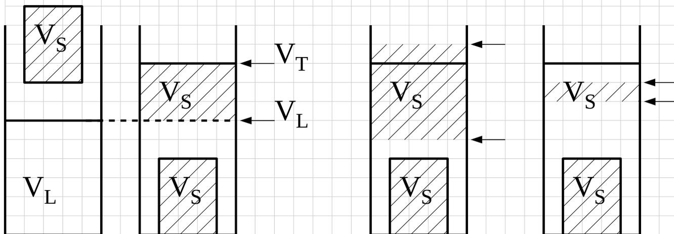
L'errore di misura del  $V_L$  e  $V_T$ , comporta un errore nella misura del  $V_S$  con la formula  $V_S = V_T - V_L$ .
